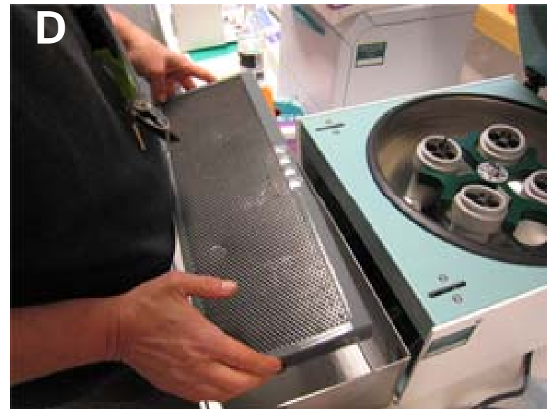
Aerosolin keruumenetelmiä: A. näytepaikka; B. adsorptiosuodin; C. elektrostaattinen suodin; D. liuotiniukoisen jakeen erottaminen suotimesta
